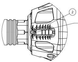
Fissare con frenafiletti. Orientare il taglio come in figura, in questo modo il grano fungerà da indicatore dell'energia dissipata nell'impatto
